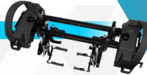
» LYNCS® es un escáner de inspección ultrasónica modular avanzado que ha sido diseñado por expertos para proporcionar mapeo de corrosión Phased Array (PAUT) y evaluación de integridad de soldadura PAUT/TOFD. Es el primer sistema verdaderamente versátil que permite a los usuarios intercambiar entre la inspección de soldaduras y el mapeo avanzado de corrosión en menos de 1 minuto.
